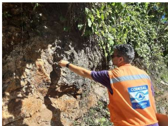
Análise estrutural das fraturas da rocha.
